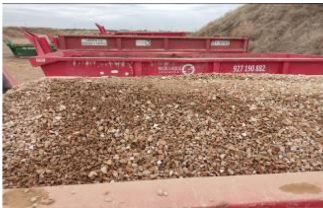
Ilustración 6 Árido reciclado mixto preparado para su venta.
